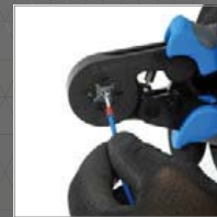
A nagy precíziású sajtolófejek a szorítóhüvelyt mindig pontosan a megfelelő formára préselik.
