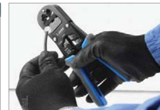
A nagy precíziós sajtolópofák a szorítóhüvelyt mindig pontosan a megfelelő formára préselik.
